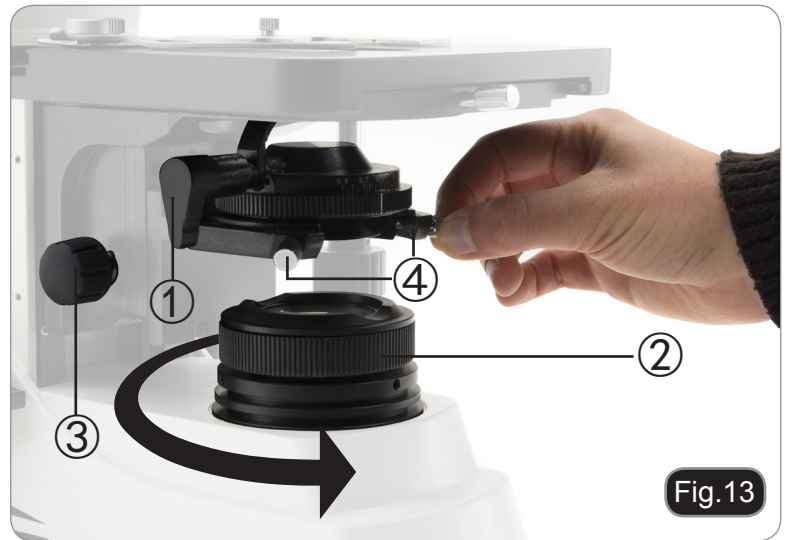
CENTRARE IL CONDENSATORE
