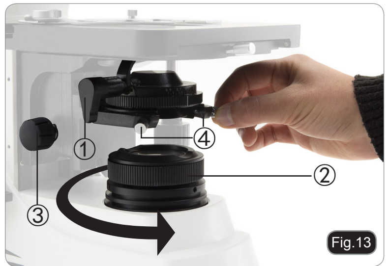
CENTRARE IL CONDENSATORE
